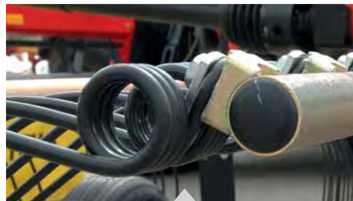
Lateral del brazo en contacto con el cultivo completamente liso
