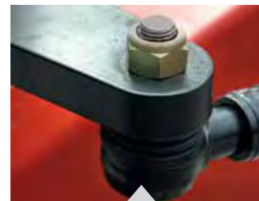
Cabezal de barras de dirección ajustable
