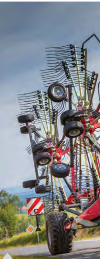
Página 10 Rastrillos MF de cuatro rotores con formación central de hileras y bastidor de transporte
