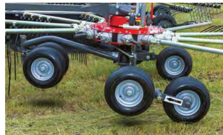
Suspensión Cardán del rotor patentada
