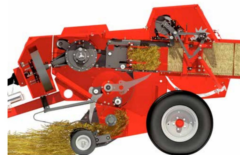
A continuación, la horquilla de la precámara eleva las láminas preformadas y las introduce en la cámara de empacado.
