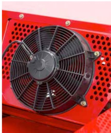
La MF 1840 incluye de serie un ventilador eléctrico que se encarga de limpiar los atadores y eliminar cualquier acumulación de restos durante el funcionamiento.
