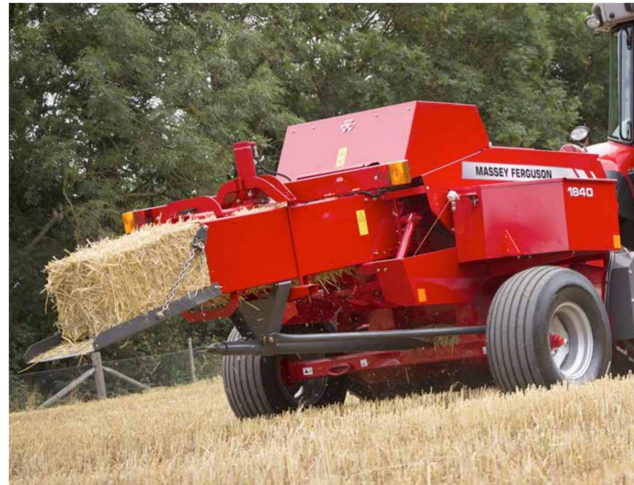
Para garantizar que la forma y la densidad de las pacas sean uniformes y perfectas más allá de las condiciones de trabajo, la cámara de empacado OptiForm tiene una longitud 460 mm mayor (un 30% más) que la del modelo anterior, la MF 1839.
