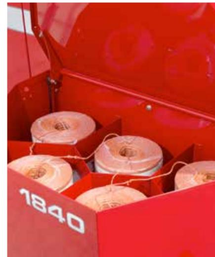
La MF 1840 tiene capacidad para guardar 10 bobinas de hilo, suficiente para las jornadas de trabajo más prolongadas. Las grandes dimensiones de cada compartimento permiten el uso de bobinas de gran tamaño para transportar todavía más hilo y producir más pacas por carga.
